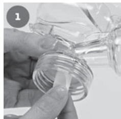
1 Вставьте белый Клапан в Соединитель снизу.
